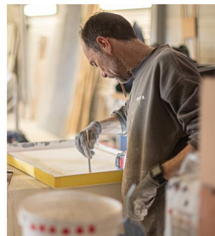
Actuellement, une vingtaine d'opérateurs et opératrices travaillent dans le composite chez Amel. Leurs missions sont multiples : drapage, collage, application du gelcoat, finition au topcoat (Résine blanche sous les planchers et dans les coffres), stratification de fabrication, stratification de finition, détourage...
