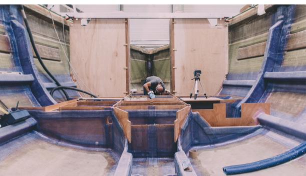
Différentes méthodes de fabrication existent dans ce domaine : la coque et le pont sont réalisés en infusion, plusieurs pièces sont moulées sous vide (capots de coffres), et d'autres pièces sont réalisées au contact, c'est-à-dire par application des matériaux au pinceau ou au rouleau.
